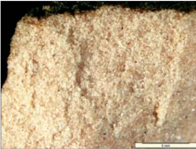
11. Obraz makroskopowy fragmentu próbki trzonu kolumny z aniołem (dep. 564).
