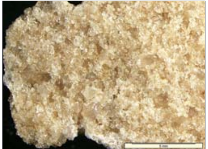
6. Obraz makroskopowy próbki trzonu kolumny (dep. 64).
