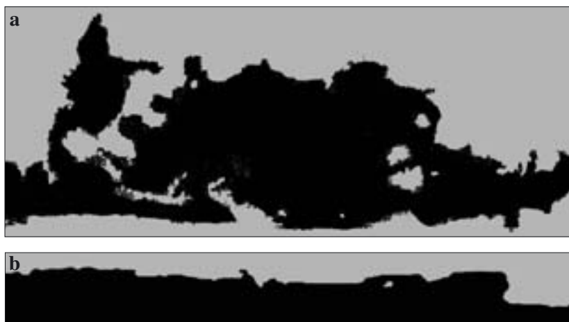
5. Identyfikacja powierzchni ubytków: a – maska ubytków warstwy malarskiej i częściowo gruntu, b – maska obszaru z widoczną powierzchnią drewna.
