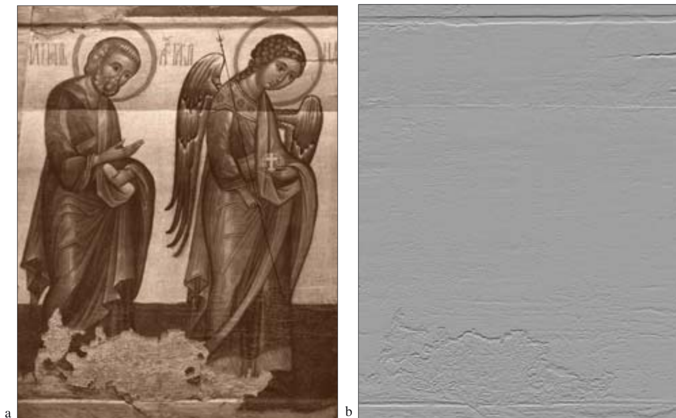
8. Ikona w świetle skośnym: a – obraz oryginalny, b – widok po usunięciu informacji o kompozycji malarskiej. 8. Icon in oblique light: a – original image, b – view after removing information about the painterly composition.
