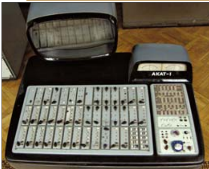
2. AKAT-I, analizator równań różniczkowych konstrukcji inż. J. Karpińskiego (1959). 2. AKAT-I – differential equation analyser constructed by engineer J. Karpiński (1959).
