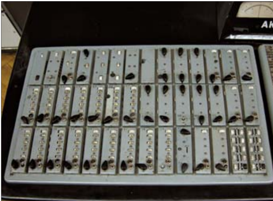
4. AKAT-I, analizator równań różniczkowych konstrukcji inż. J. Karpińskiego (1959): a – fragment pulpitu sterowania, b – krosownica.
