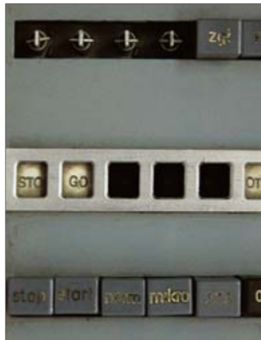
10. Fragment pulpitu sterowania (przed renowacją) minikomputera KAR-65 konstrukcji inż. J. Karpińskiego (1965).
