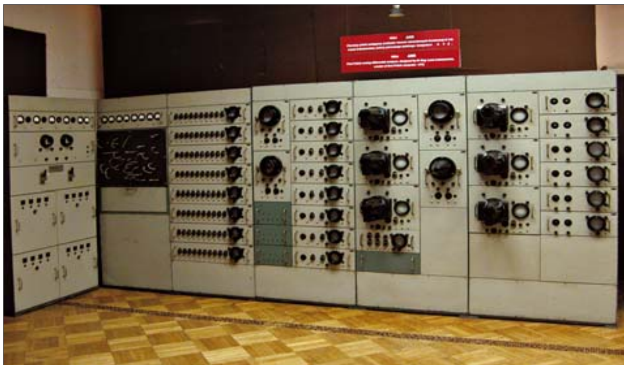
5. Analizator Równań Różniczkowych, pierwszy polski „komputer” analogowy konstrukcji inż. L. Łukaszewicza (1958). 5. Differential Equation Analyser – first Polish analogue “computer” constructed by engineer I. Łukaszewicz (1958).
