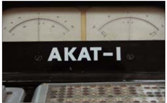
3. Fragment pulpitu sterowania AKAT-I, analizatora równań różniczkowych konstrukcji inż. J. Karpińskiego (1959).
