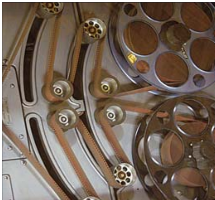
7. Fragment pamięci taśmowej elektronicznej maszyny cyfrowej (komputera) National-Elliott 803 B produkcji brytyjskiej (1962). 7. Fragment of the magnetic tape memory of the National-Elliott 803 B digital machine (computer) produced in the UK (1962).
