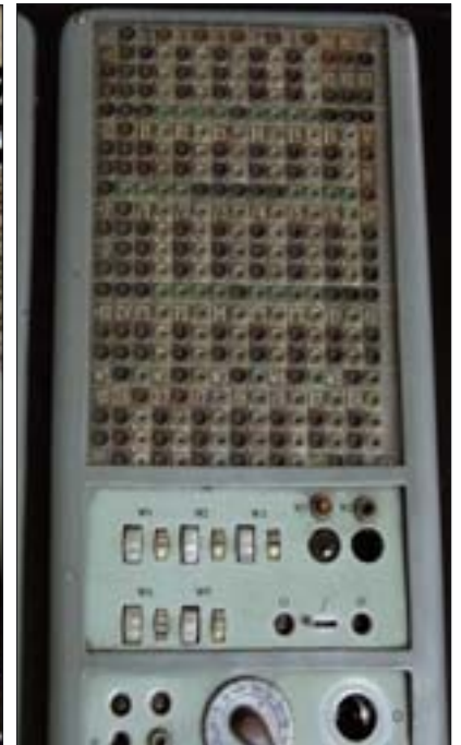
4. AKAT-I, analizator równań różniczkowych konstrukcji inż. J. Karpińskiego (1959): a – fragment pulpitu sterowania, b – krosownica.
