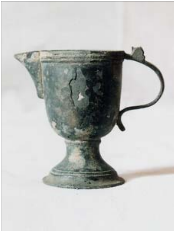
16. Dzbaneł cynowy zarażony „rakiem cyny”, z widocznymi białymi przebarwieniami i ubytkami. Fot. B. Sebzda. 16. Pewter jug contaminated with so-called pewter cancer and with visible white spots and gaps. Photo: B. Sebzda.
