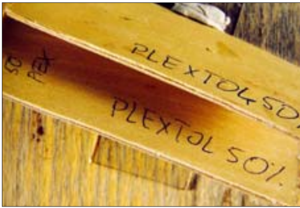
19. Wytrzymałość spoin Plextolu D498 i poliocetanu winylu na zmienne warunki wilgotności. Fot. R. Szelwach.
