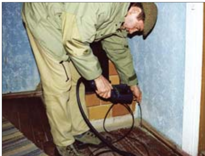
4. Badania videoendoskopowe w skansenie w Sierpcu. Ocena stanu zagrzybienia stropu przyziemia. Fot. P. Witomski.
