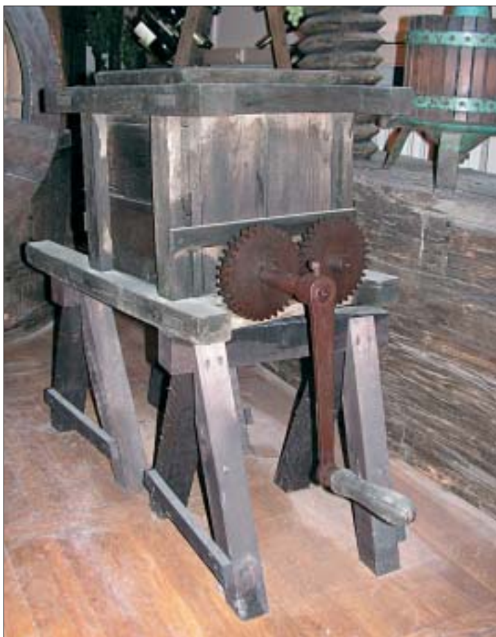
21. Miazgownica ręczna z XIX w., konstrukcja główna „na noszach”. Zbiory Muzeum Ziemi Lubuskiej w Zielonej Górze. Fot. A. Jackiewicz, 2006 r. 21. Nineteenth-century manual pulp container, main construction “on stretchers”. Collections of the Lubuska Land Museum in Zielona Góra. Photo: A. Jackiewicz, 2006.
