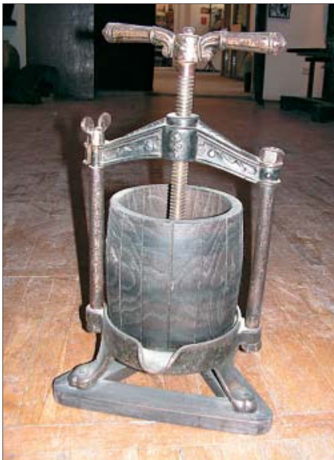
23. Żeliwna prasa jednośrubowa z XX w. w ozdobnej ruchomej ramie. Zbiory Muzeum Ziemi Lubuskiej w Zielonej Górze. Fot. A. Jackiewicz, 2006 r.
