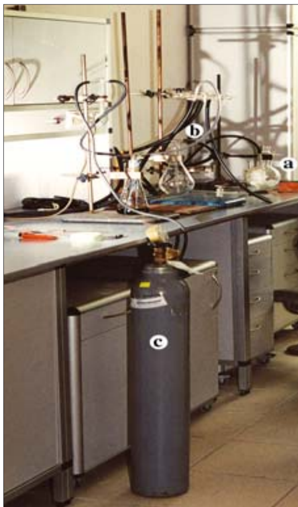
1. Aparatura do fumigacji gazami niereaktywnymi: a) kolba z larwami; b) system przewodów; c) źródło gazu (butla).
