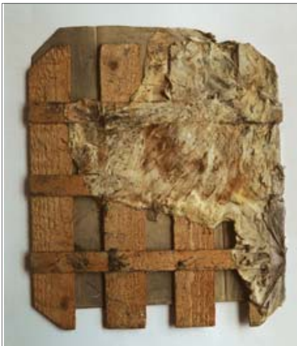
11. Parkiet na podobrazu porażony przez grzyba domowego. Fot. Archiwum ZKD SGGW.
