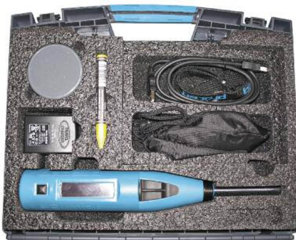
1. Zestaw młotka Silver Schmidt firmy Proceq. Fot. P. Filipowicz.
