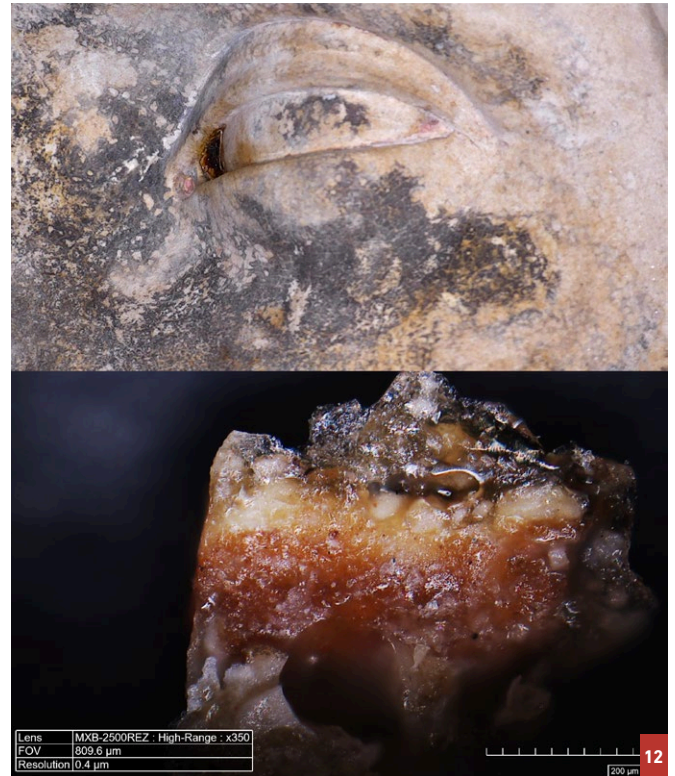
11 Warstwy pobrane z kącika lewego oka Marii, Pietà z Nowego Miasta Lubawskiego. Przekrój stratygraficzny w świetle odbitym (górną fotografią) oraz fluorescencją próbki wzbudzona promieniowaniem uv (dolna fotografia). Niebieską strzałką oznaczono pomarańczowy podkład. Fot. E. Jeżewska
