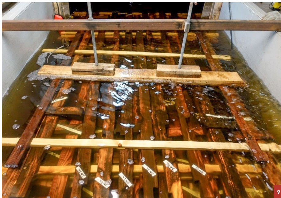
9 Kąpiel dynamiczna elementów z baraku B-167. Widoczne odpowiednio oznaczone elementy i ich zabezpieczenie przed wypływaniem na powierzchnię. Fot. M. Lach Dynamic bathing of elements from barracks B-167. Visible, properly marked elements and their prevention from floating to the surface. Photo: M. Lach
